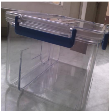
Slika 8. Inkubacija zasejanih podloga: zasejane podloge se inkubiraju u kutiji ili loncu koji se hermetički zatvaraju, sa dodatkom sistema (kesice za mikroaerofiliju) koji obezbeđuje potreban atmosferski sastav
